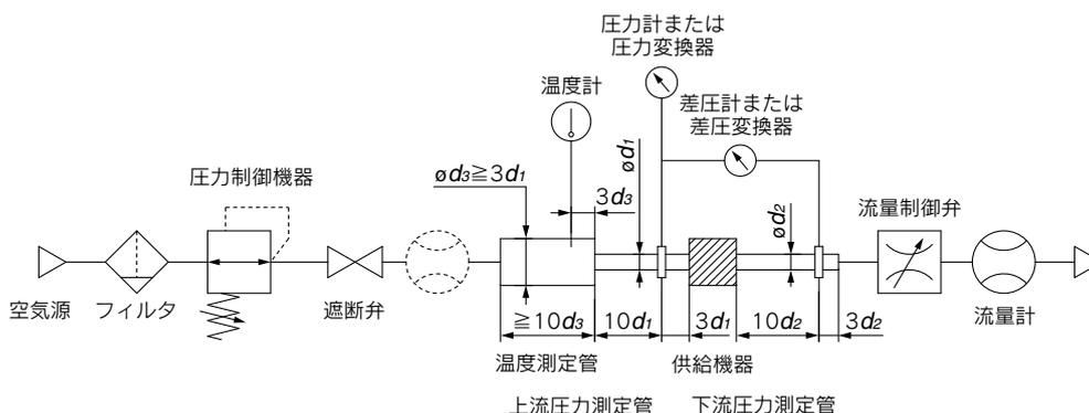
図2. ISO6358:1989, JIS B 8390:2000 の試験回路
