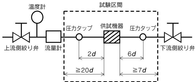
図4. IEC60534-2-3, JIS B 2005-2-3による試験回路
