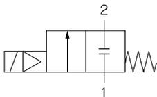
弁閉時、INとOUTはブロック状態(+)となっておりますが、“ポート2の圧力>ポート1の圧力”
