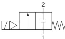
弁閉時、INとOUTはブロック状態(+)となっておりますが、“ポート2の圧力>ポート1の圧力”の場合、流体をブロックすることはできません。
