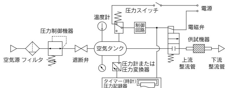
図3. JIS B 8390:2000 の試験回路
