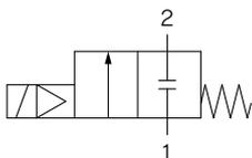
弁閉時、INとOUTはブロック状態(+)となっておりますが、“ポート2の圧力>ポート1の圧力”の場合、流体をブロックすることはできません。
