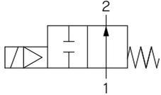
弁閉時、INとOUTはブロック状態(+)となっておりますが、“ポート2の圧力>ポート1の圧力”の場合、流体をブロックすることはできません。
