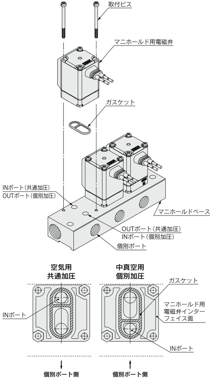
※マニホールドベースへの電磁弁の取付けは方向性があります。
