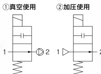
弁閉時、INとOUTはブロック状態(+)となっておりますが、“ポート2の圧力>ポート1の圧力”の場合、流体をブロックすることはできません。
