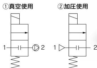
弁閉時、INとOUTはブロック状態(+)となっておりますが、“ポート2の圧力>ポート1の圧力”の場合、流体をブロックすることはできません。
