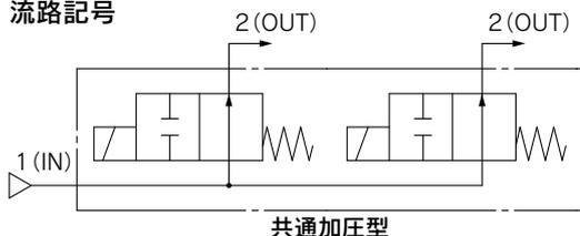
弁閉時、INとOUTはブロック状態(+)となっており、"ポート2の圧力>ポート1の圧力"の場合、流体をブロックすることはできません。
