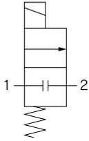
弁閉時、INとOUTはブロック状態(≡)となっておりますが、“ポート2の圧力>ポート1の圧力”の場合、流体をブロックすることはできません。
